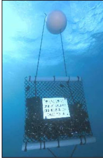
Εικόνα 3.4.1. Κλωβός με μύδια του είδους Mytilus galloprovincialis που τοποθετήθηκε στην περιοχή του ναυαγίου για τη μελέτη τυχόν βιοσυσσώρευσης ρύπων
